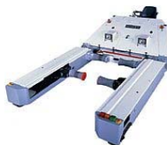
Power Push Unit, conçu pour être attaché à l'une des roues du train avant.
