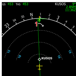
Le point "top of descent", calculé par le FMGC, est montré avec une flèche blanche vers le bas (1)
