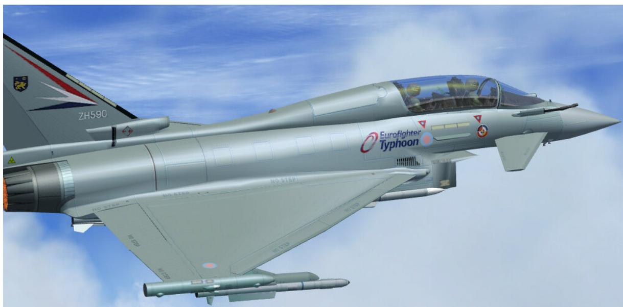
Für den Einsatz gegen Bodenziele kann der Eurofighter auf ein weites Spektrum an Waffen zurückgreifen. In einer typischen Mission würde er beispielsweise mit einem Waffenmix aus der Mauser-Bordkanone, 4 Mittelstrecken-Luft/Luft-Flugkörper (Meteor, AMRAAM) und 2 Kurzstrecken-Luft/Luft-Flugkörper (IRIS-T, ASRAAM) zur Selbstverteidigung sowie bis zu 6 lasergelenkten Bomben beladen werden.
