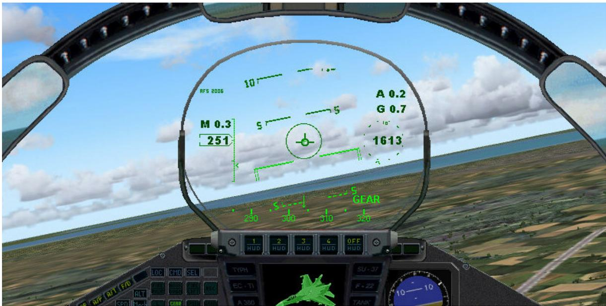
Das Frontscheibensichtgerät ist die zentrale Informationsquelle für den Flugzeugführer. Wegen seines schmalen Rahmens ist die Sicht nach vorne kaum eingeschränkt. Das fortschrittliche optische Design gewährleistet in Verbindung mit einem flachen, einteiligen holographischen Projektionselement ein Gesichtsfeld von 30° Azimut und 25° Elevation.
